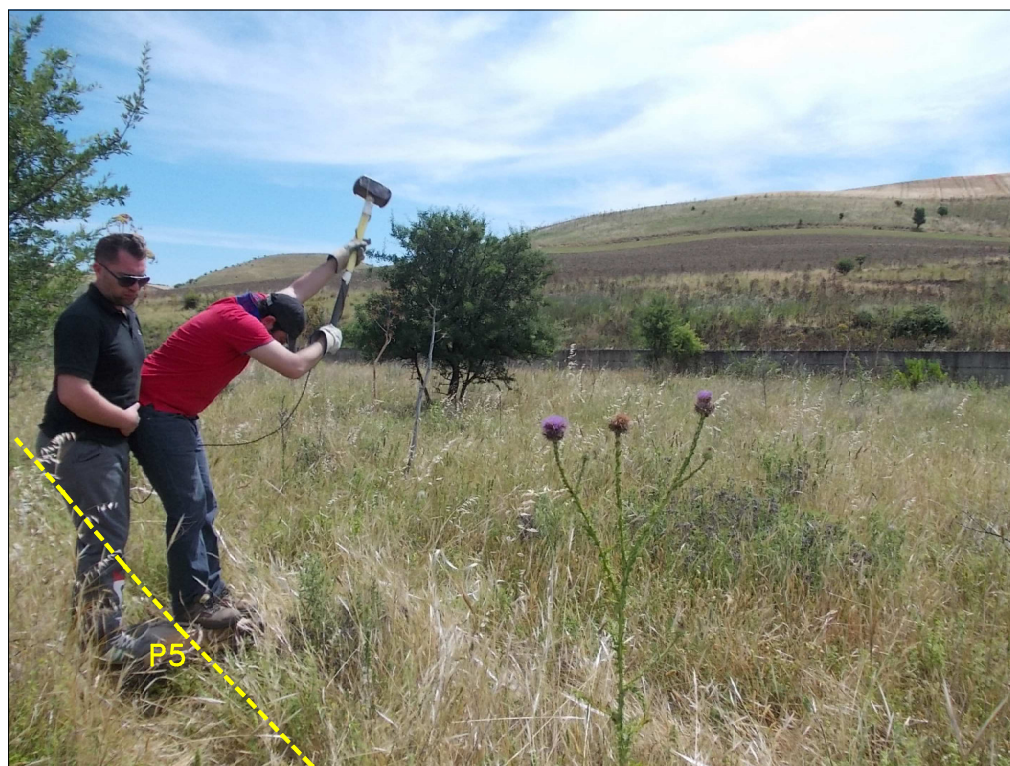
Foto 6: Postazione ed allineamento del MASW.1 – particolare della battuta in onde di Love nel punto di scoppio P5 –
