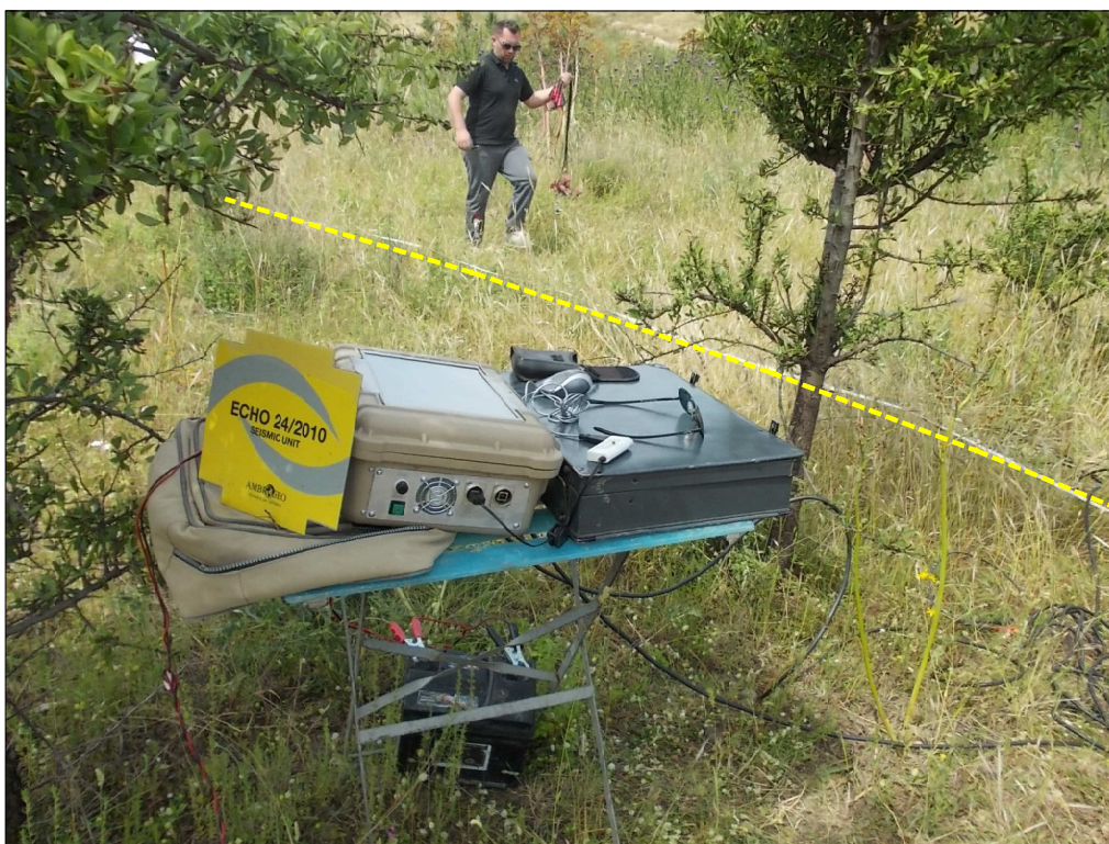
Foto 3: Postazione ed allineamento del MASW.1 – particolare della stazione di acquisizione dei dati sismici –
