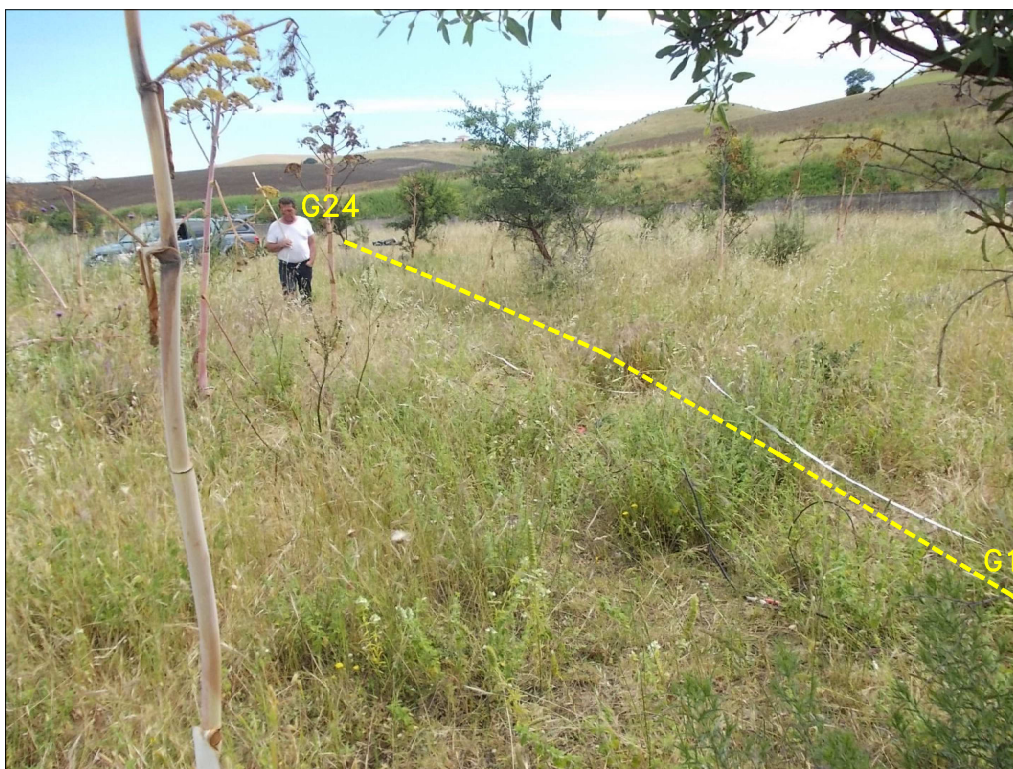
Foto 1: Postazione ed allineamento del MASW.1 – punto di vista nei pressi della postazione geofonica G1, da SO verso NE –
