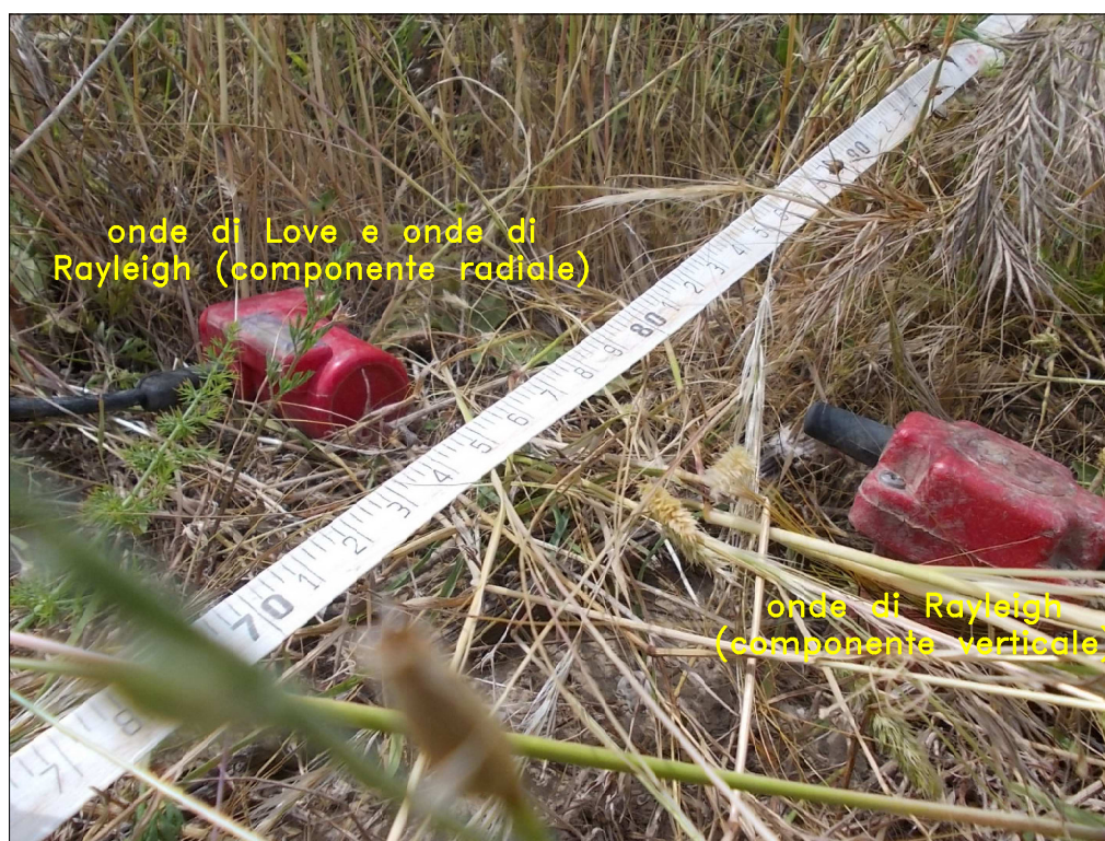
Foto 4: Postazione ed allineamento del MASW.1 – particolare dei geofoni (a 4.5 Hz) utilizzati nella prova MASW.1
