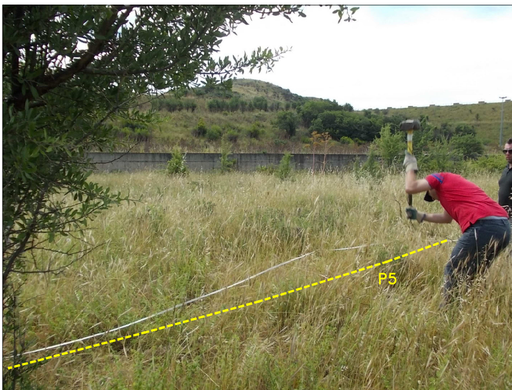
Foto 5: Postazione ed allineamento del MASW.1 – particolare della battuta in onde di Rayleigh (componente verticale) nel punto di scoppio P5 –
